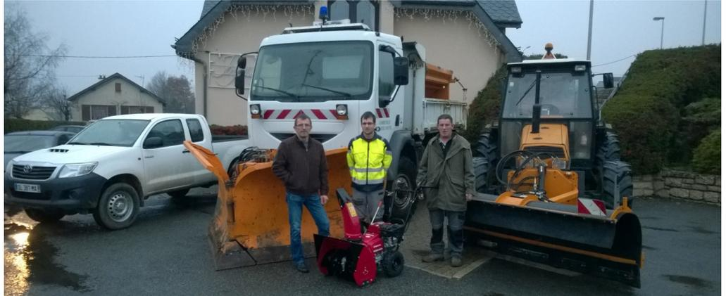
Heureusement les employés communaux avaient déjà équipé les deux engins de déneigement : le tracteur équipé d'un petit rabet de raclage intervient principalement dans les rues étroites du bourg. Le camion muni d'une étrave papillon assure le service sur
